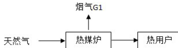
图2-1 燃气锅炉供热工艺流程图
